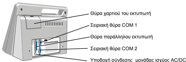
Εικόνα 2. Θέση των υποδοχών σύνδεσης
